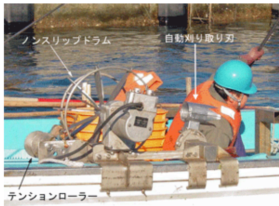
写真1 桁送り機と自動刈り取り刃
