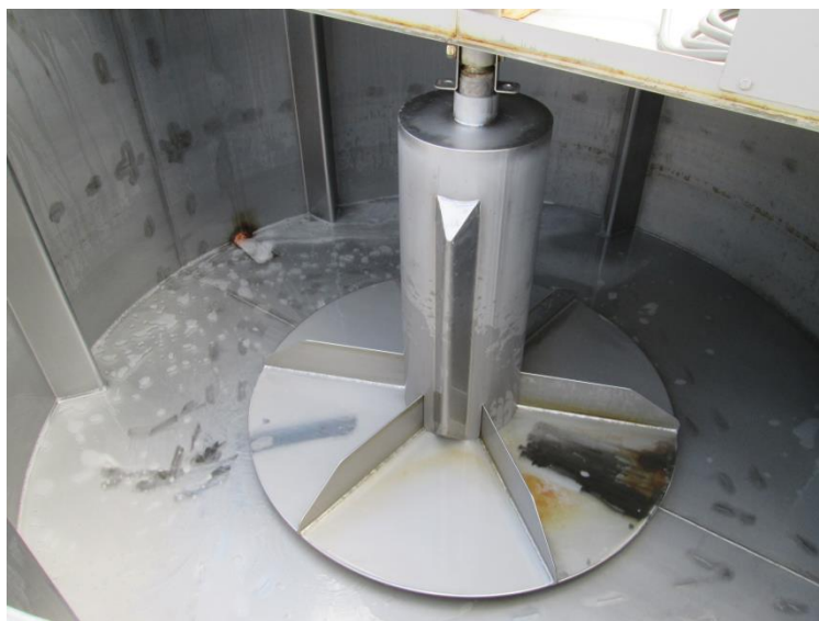
図 7 平成 29 年春に登場したステンレス製の回転軸用カバー
