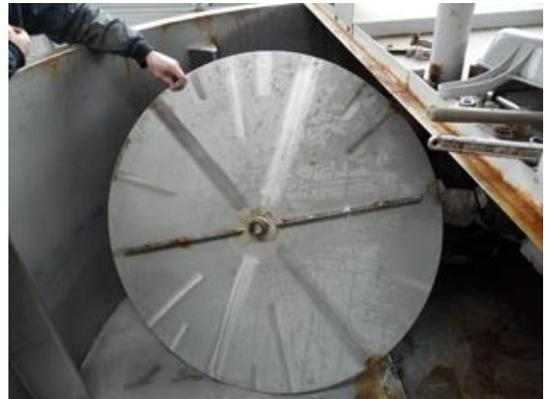
図6 攪拌翼を外した様子
