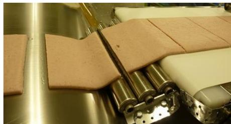
図4 通電加熱中のイカ潰し肉の収縮により発生した亀裂(左)と解決後構築した自動生産ライン(右)
