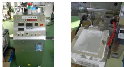
図2 実証試験のため県内企業に設置した凍結ウニ製造機械ウニ用電源(左)及び加熱部(右)
