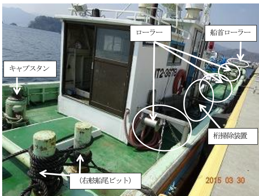
図2 関連装置等の設置状況
