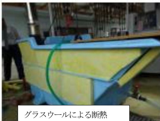
図 1 断熱材を貼り付けたボイル釜
