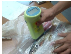
簡易鮮度・品質評価装置 による市場での鮮度、 品質状態の把握
