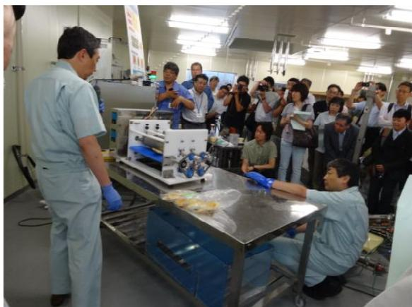
ロール式加熱装置によるサキイカの加工の様子
