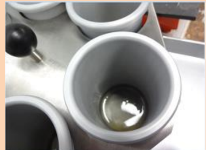
抽出した脂肪の重量を測り、魚肉の脂肪割合を計算します
