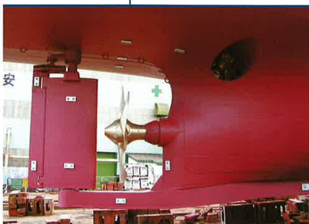
フラップ舵・スタンスラスター
