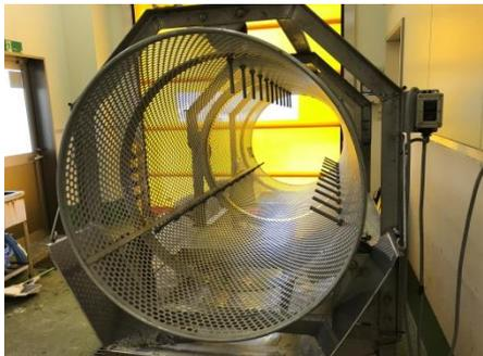
塩落とし：ドラム部を回転させ、1度に約60kgの塩蔵ワカメの塩を落とします。
