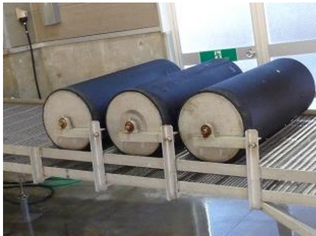
図4 水切り用の脱水ローラー（3連式）
