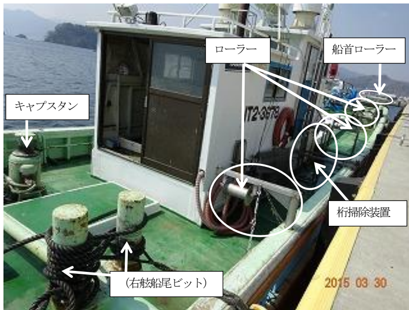
図2 関連装置等の設置状況
