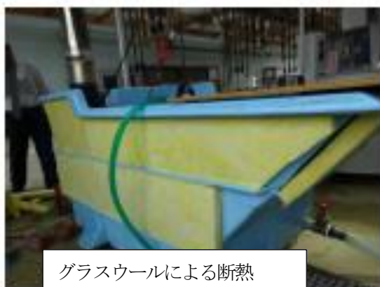
図 1 断熱材を貼り付けたボイル釜
