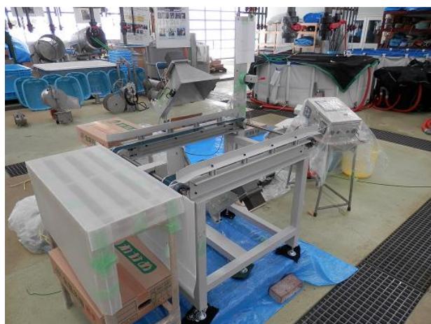
写真4 コンベアーによる搬送機構を備えた湯通し塩蔵ワカメ製品用マイクロ波水分計のプロトタイプ
