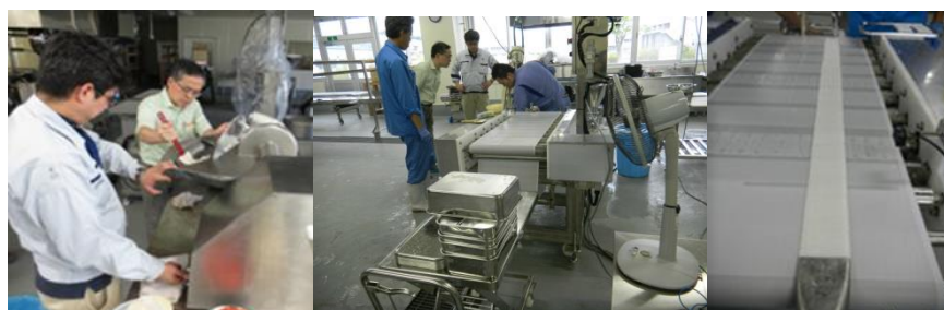
図 1 イカソフト化食品の製造の様子（左からすり身調製、通電加熱装置、連続成形）
