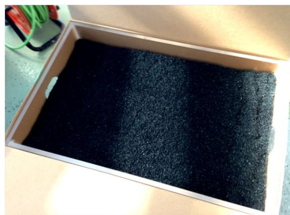
写真3 試料セルへの試料充填例(乾燥カットワカメ)
