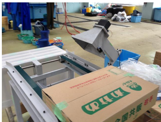
写真4 コンベアーによる搬送機構を備えた湯通し塩蔵ワカメ製品用マイクロ波水分計のプロトタイプ
