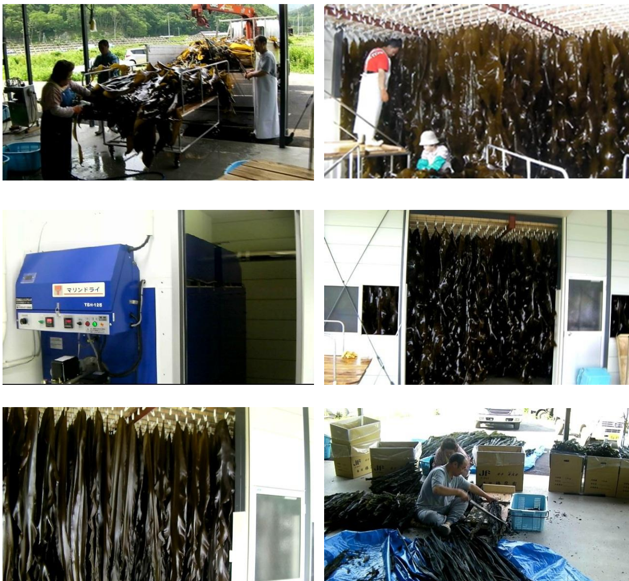
写真 2 共同利用乾燥施設の運用 (コンブ搬入、吊り下げ、乾燥、梱包)
