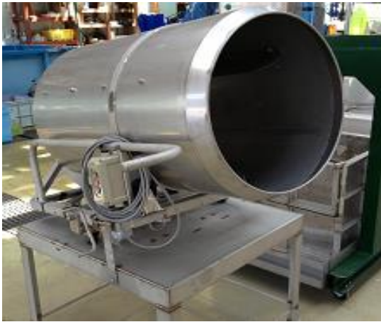
写真1 従来法に用いられる塩漬け用ミキサー
