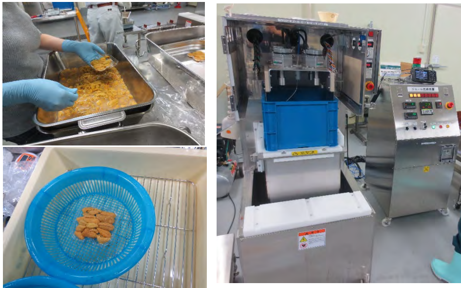
図2 バッチ式通電加熱装置（22L 水槽、生産機）による凍結ウニの試作の様子 左上：むき身を穴あきトレーに整列する様子 左下、ウニざるにトレーを載せたものを4つ作成し積み重ねて水槽で処理 右：処理装置全体
