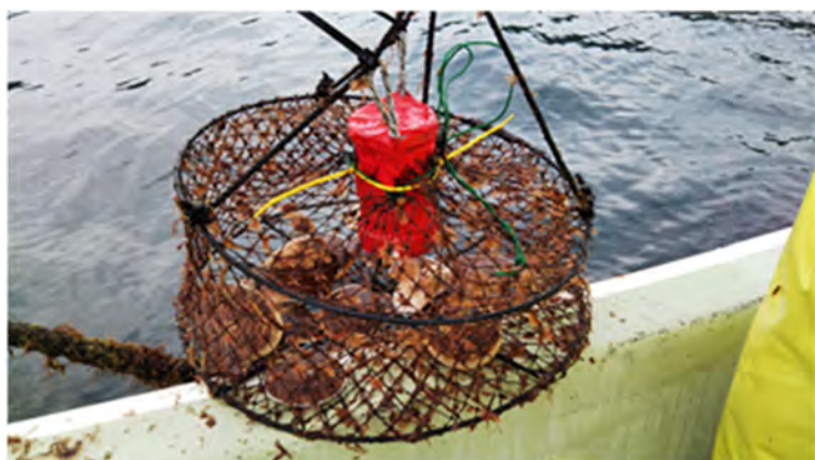
図3 カゴにタイムラプスカメラを設置した様子
