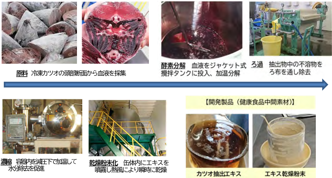
図1 セレノネイン中間素材の製造工程
