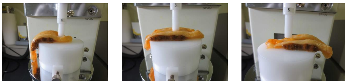
図2 クリープメーターでの測定位置
