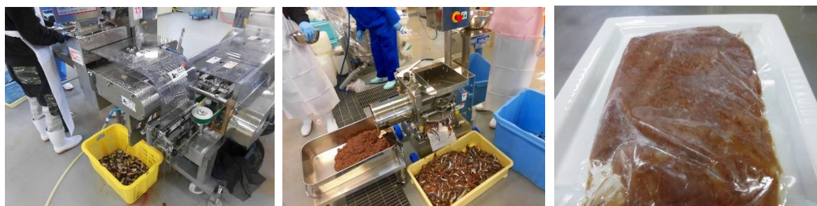
図1 マイワシ落し身製造過程について（小型裁割機、魚肉採取機、落し身）
