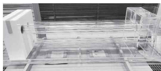
図 2 遊泳力測定装置（（有）タカツ産業社製）
