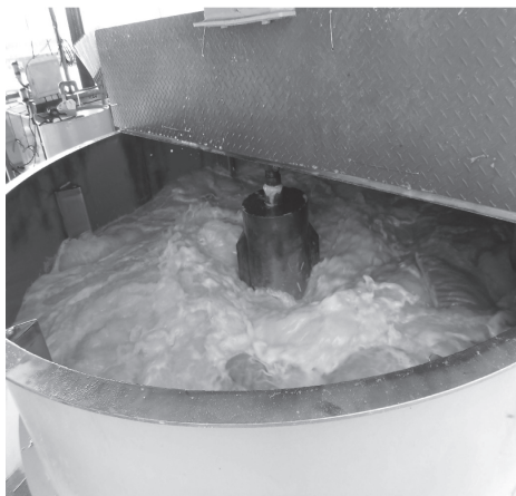
図1 高速攪拌塩漬装置（しおまる）による海藻の塩漬
