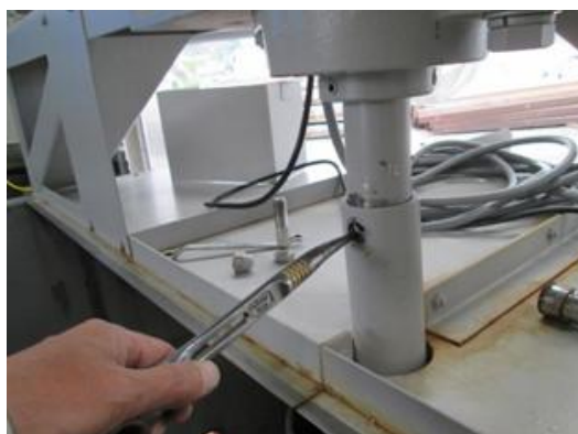
写真 35 攪拌翼と振れ止めの位置合わせ
