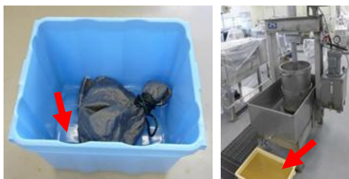
写真 17 塩漬の完了確認（左：滲出液による確認、右：圧搾液による確認）
