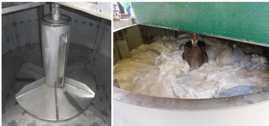
写真 26 ステンレス製の回転軸カバーおよび塩漬時の様子
