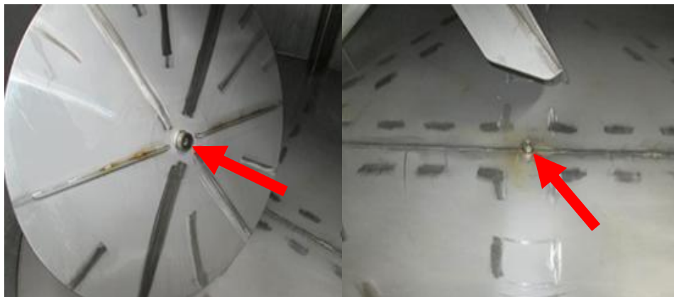
写真 33 攪拌翼の底面（左）および振れ止め（右）
