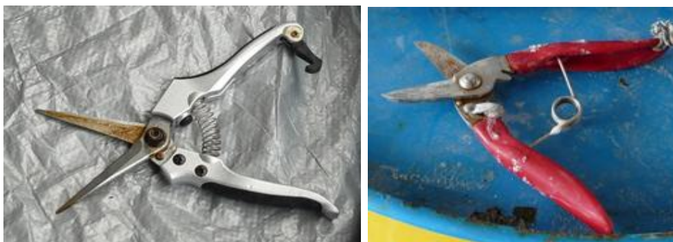
写真 23 結束バンドを切断する工具の使用事例
