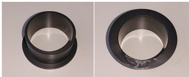
写真30 樹脂製治具（ブッシュ）の表側（左）と裏側（右）
