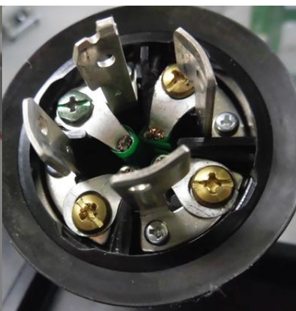
写真4 コンセント内部 （緑色のアース線）
